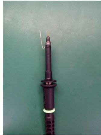
图6 使用探针的探头
