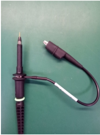
图5 带长地线的探头
