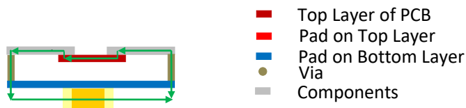
图4 GaN 变换器常规垂直功率环路：侧视图
